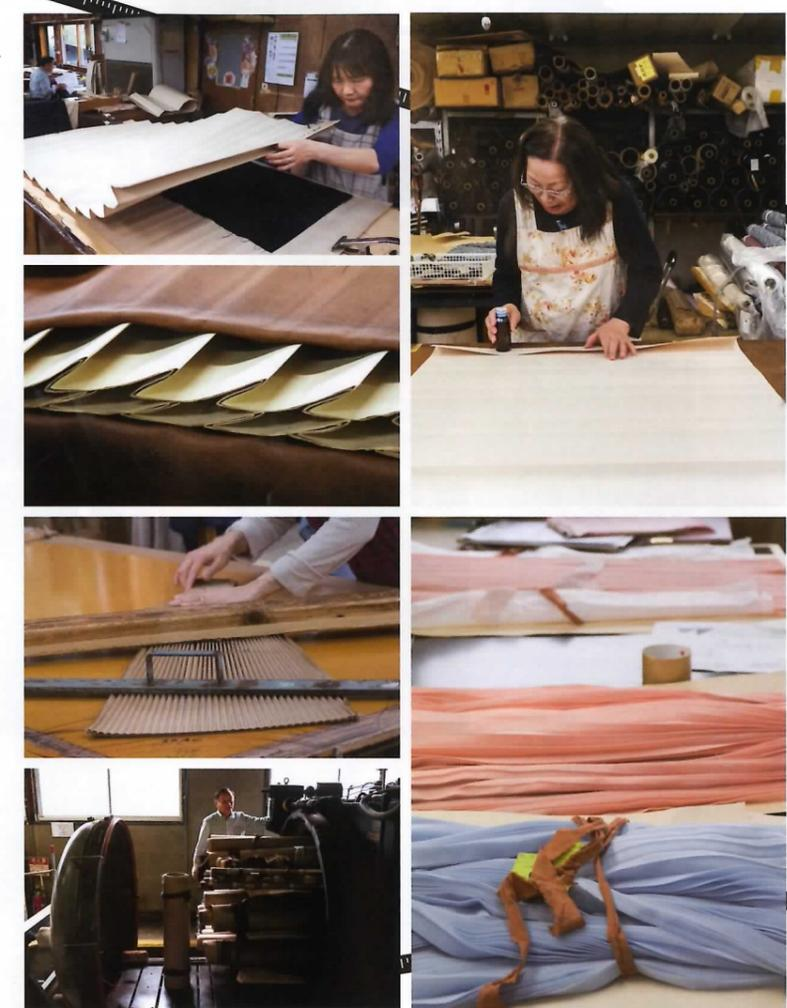
プリーツ加工はカルトン紙でプリーツの型紙をつくることから始まる。CADデータを元に専用マシンでカルトン紙に折り目をつけ、それを手で丁寧に折っていく。「リボビタンドのピンで折ると一番うまくいくんです(笑)」。型紙を2枚つくり、布をはさんで型どおりに折り込んでいく。その型紙と布を専用の大きな心棒にきつく巻き付けて、真空と100度前後の蒸気の排出が繰り返されるスチーム釜で30分熱する。カルトン紙は蒸気を通しやすい特殊紙なので、ポリエステル系の布などにしっかり熱が加わり、可塑性で折り目がつく。30分ほど冷ますと完成。折り目の細かいアコーディオンプリーツなども同じ要領でつくられるが、いままでもなく、すべて丁寧なプロの手作業が必要になる。
